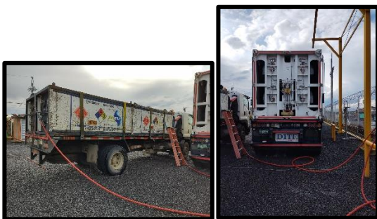
Imágenes No 5 y 6. Proceso de llenado de los módulos. Fuente: Autor
