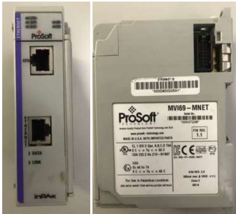
Figura 15. Tarjeta de comunicaciones ProSoft MVI69-MNET
