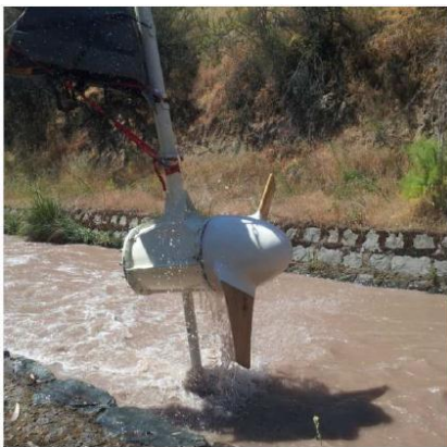
fig. N° 7 Turbina de eje horizontal.
