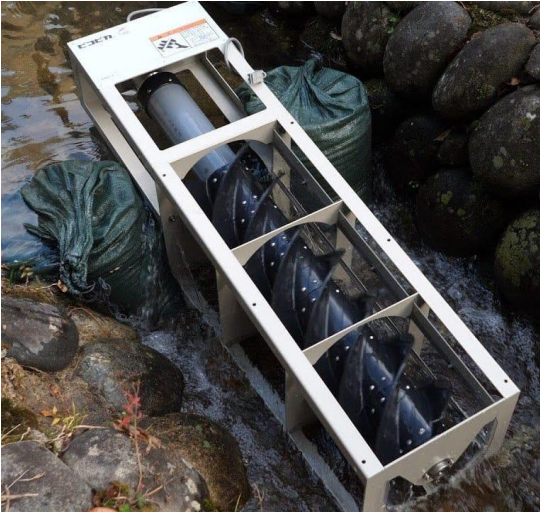
Fig. N° 12 Mini generador eléctrico
