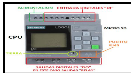
Ilustración 21 :Identificación de partes del PLC LOGO SIEMENS®
