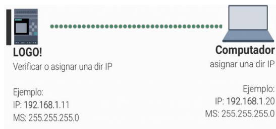
Ilustración 26 Conexión y direccionamiento de la conexión Ethernet entre el PLC y el ordenador
