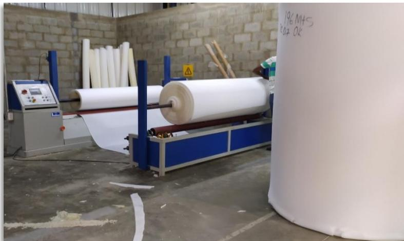
*Ilustración 20 área de corte de bloques de espuma (continuo)*
