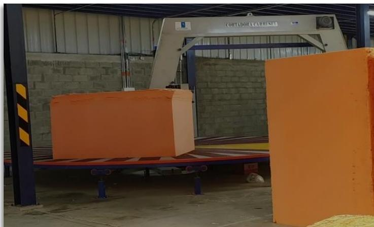
*Ilustración 18 área de corte de bloques de espuma (carrusel)*
