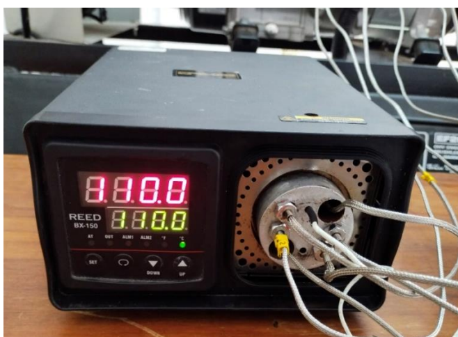
Figura 8 – Bloque térmico (REED BX-150).
