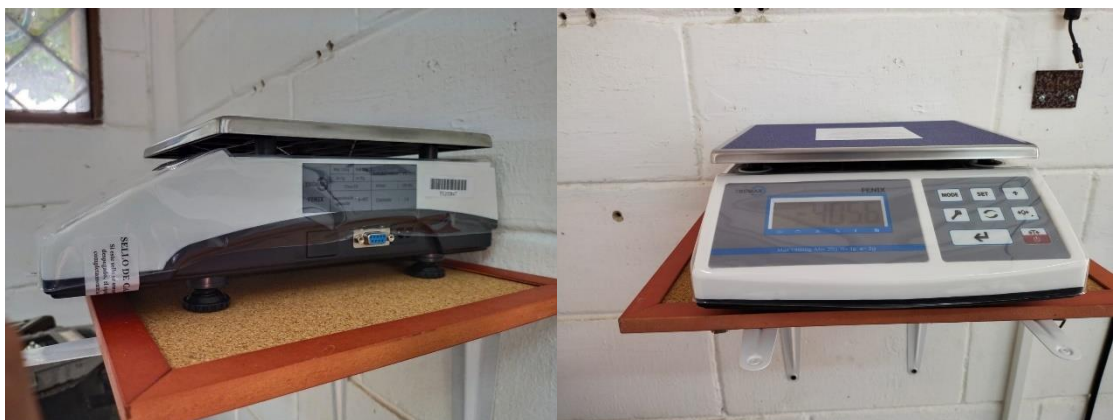
Figura 6 – Báscula TRÚMAX (Modelo: Fénix; Número de Serie: YS200847; Cap. Máx.: 15 kg; Resolución: 1 g).
