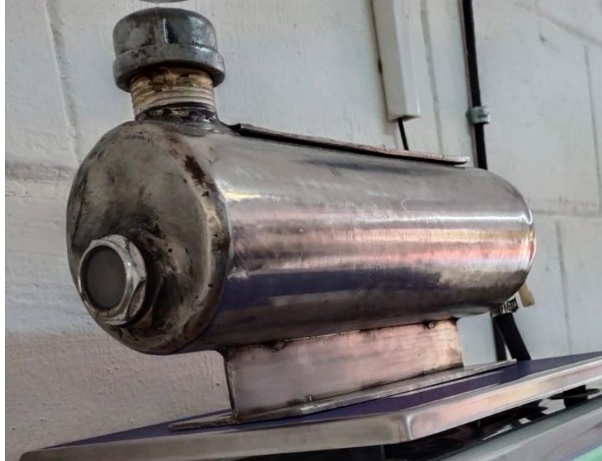
Figura 5 – Tanque de combustible en acero inoxidable 304.
