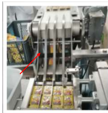
Figura 17: dispositivo de alimentación por gravedad instalado en el equipo
