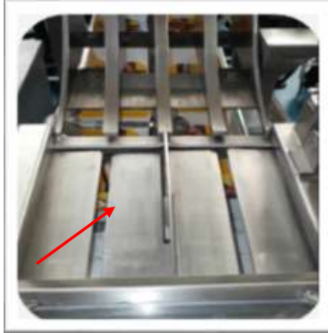
Figura 18: compuertas de descarga instalada
