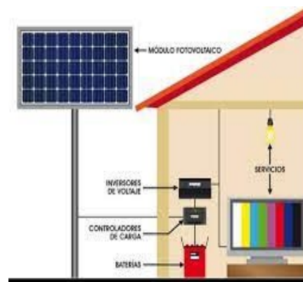
Figura 2. Sistema fotovoltaico tipo isla
