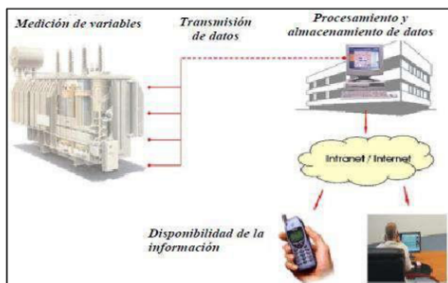
Imagen 2. 14 Diagrama de tipología de sistema de monitoreo de transformadores.
