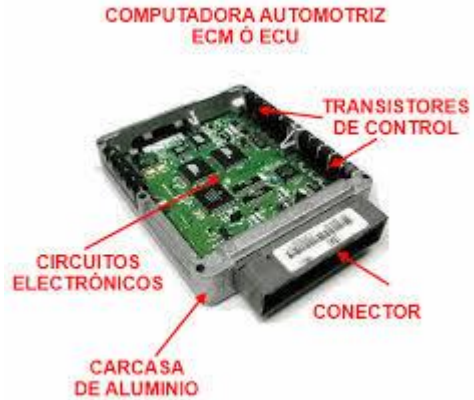
Modulo de control electrico
