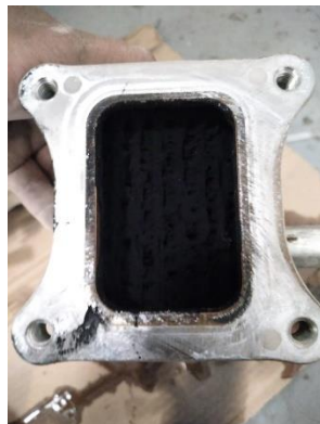
Entrada de enfriador con exceso de carbón
