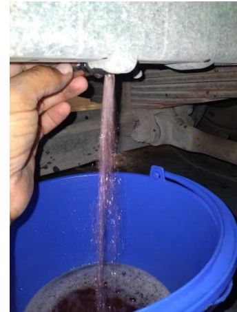
Retiro de líquido refrigerante
