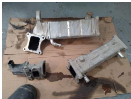
Enfriadores y válvulas con exceso de carbón
