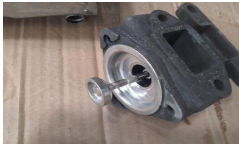
Válvula sin exceso de carbón
