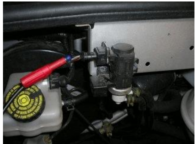
Solenoides de un sistema de rectificación de gases de escape
