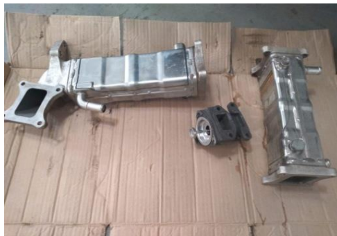
Válvula y enfriadores limpios
