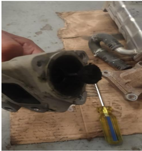
Interior de la válvula con exceso de carbón
