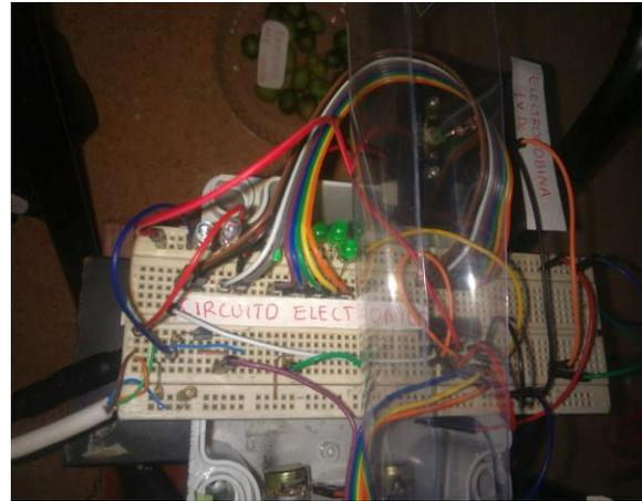
**Figura 17:** Montaje final circuito integrado en protoboard para activación sensor CNY70. Fuente: Elaboración propia.
