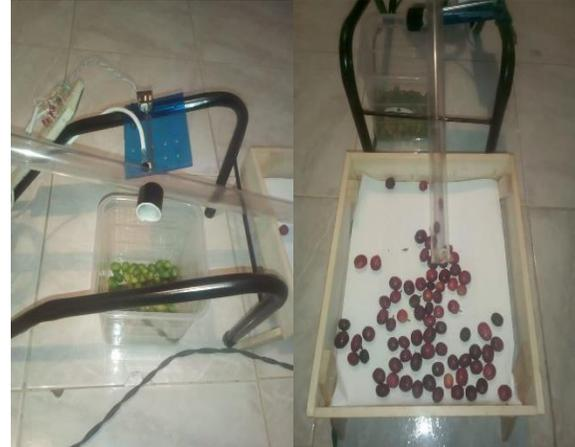
**Figura 21:** Instalación ducto y recipientes para recepción de frutos de café. Fuente: Elaboración propia.
