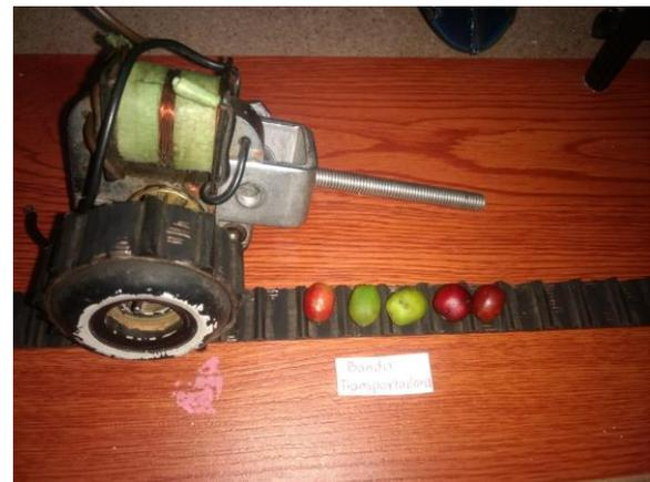
**Figura 22:** Banda transportadora. Fuente: Elaboración propia.
