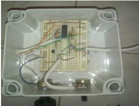
**Figura 15:** Montaje circuito integrado en protoboard. Fuente: Elaboración propia.
