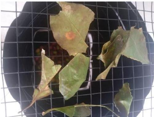
**Figura 20:** Malla para separación de frutos e impurezas. Fuente: Elaboración propia.
