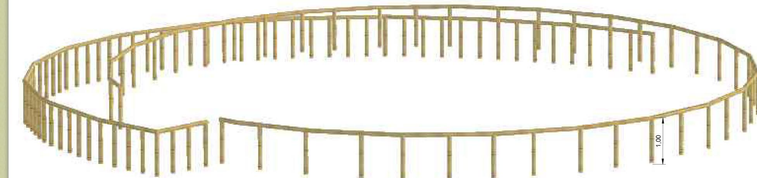
Barandas en guadua
