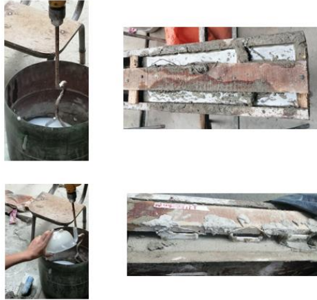
Figure 31 Fuente propia. Elaboración de la mezcla y vertido en molde
