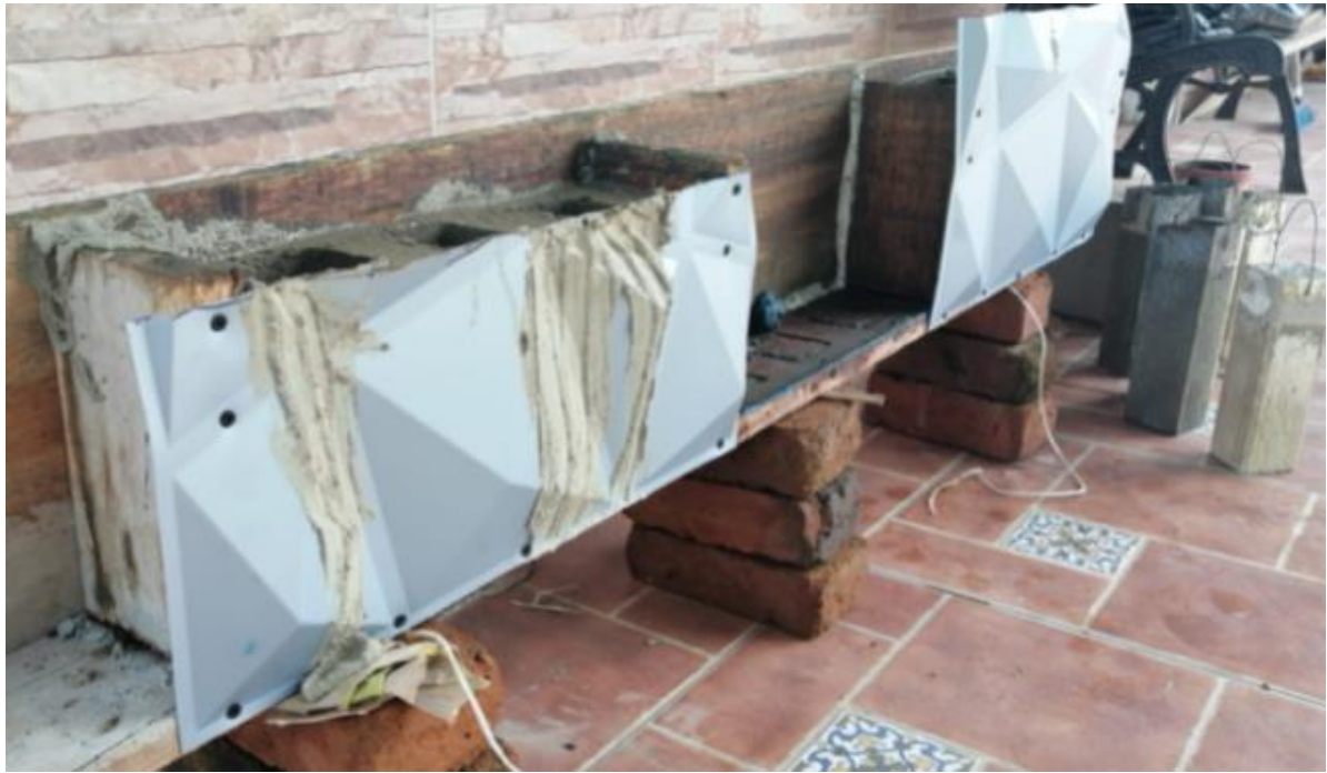
Figure 67. Fuente propia. Formaleta usada para los bloques con textura.
