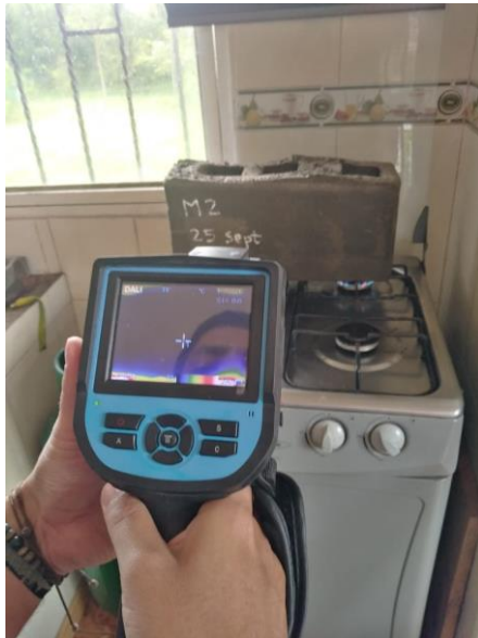
Figure 51. Fuente propia. prueba de temperatura cámara térmica muestra M2
