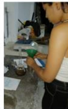
Figure 39. Fuente propia. Procedimiento para tomar muestra triple s (sss, saturado superficialmente seco)
