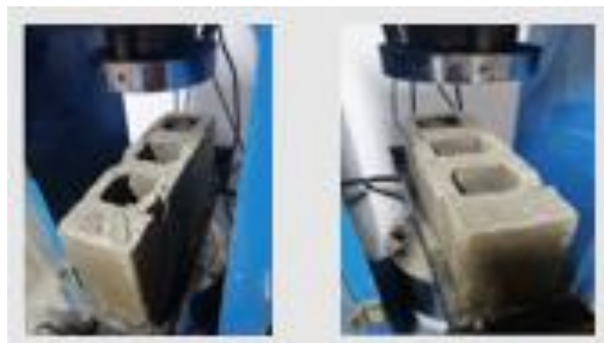
Figure 53. Fuente propia. Resultado de prueba se muestran fisuras en el bloque
