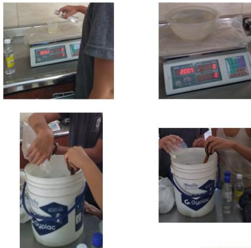
Figure 30. Fuente propia. Elaboración del espumante.
