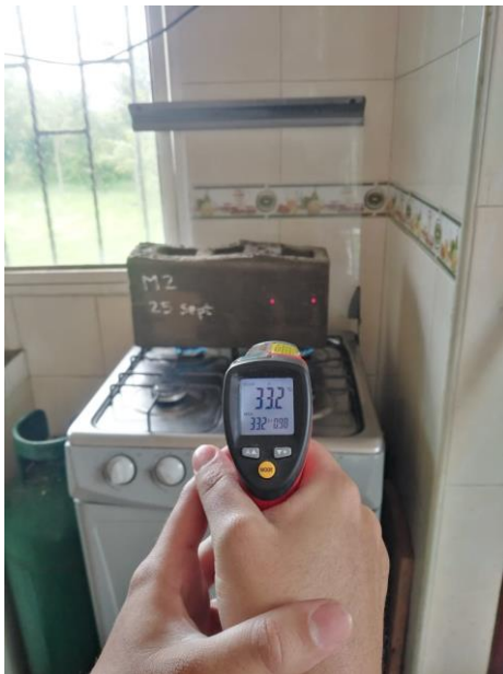
Figure 49. Fuente propia. prueba de temperatura pistola termómetro infrarrojo.
