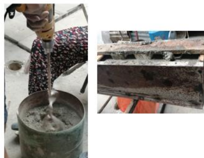
Figure 23. fuente propia. Realización de bloque celular
