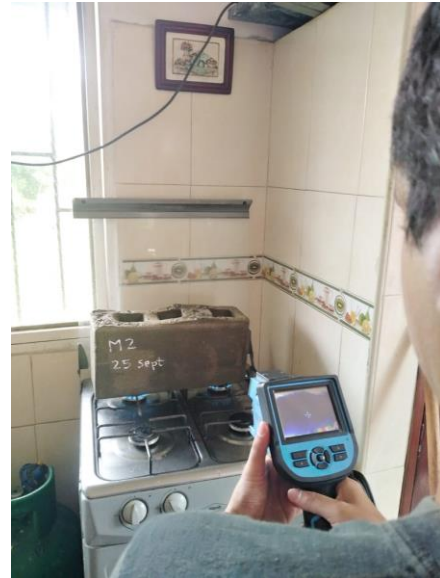
Figure 50. Fuente propia. prueba de temperatura cámara térmica muestra M2 segundo intervalo de tiempo.
