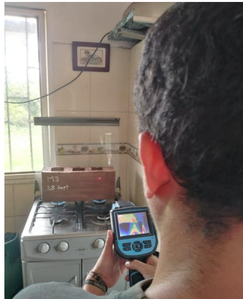
Figure 48. Fuente propia. prueba de temperatura cámara termográfica a bloque M3 color
