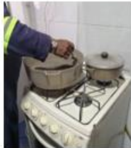
Figure 35. Fuente propia. Laboratorio de arena, secado se muestras
