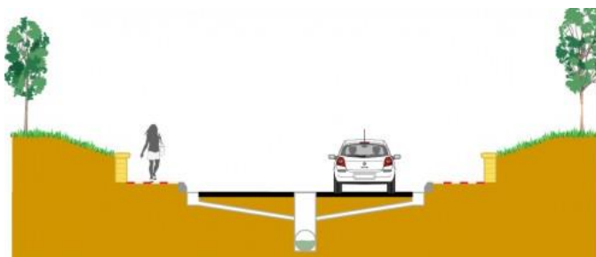
Figura 122 DRENAJE DE CARRETERA
