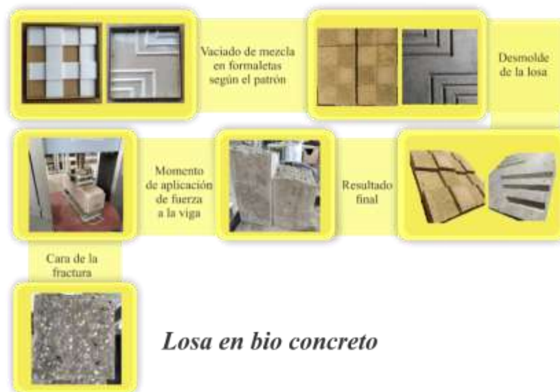
Ilustración 4. Proceso de elaboración de losas en bioconcreto a base de cascarilla de café
