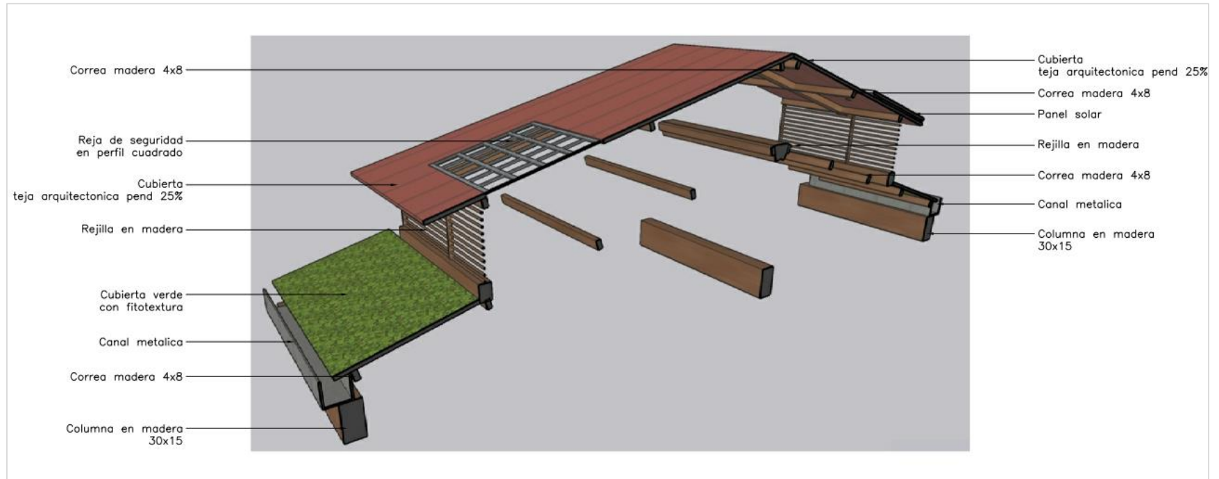
Figura 66. Detalles Constructivos Vivienda Sostenible. Fuente: Propia
