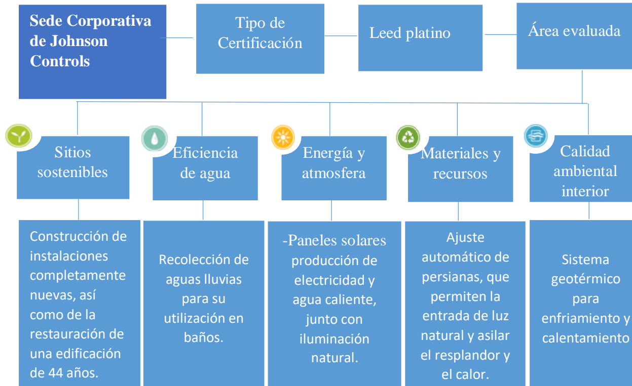
Figura 15. Sede Corporativa de Johnson Controls en Glendale, Winsconsin, Estados Unidos y su certificación LEED. Fuente: Propia con base a datos de (Jessenia Pulido Perez, 2013)
