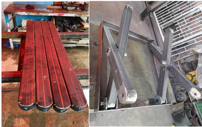
Figura 7- 4: Evidencias de perforación de brazos de las tijeras
