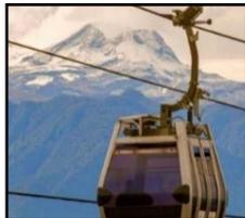
**Teleférico:** Sistema de cabinas suspendidas fijamente que a su vez es transportado por un cable alterno
