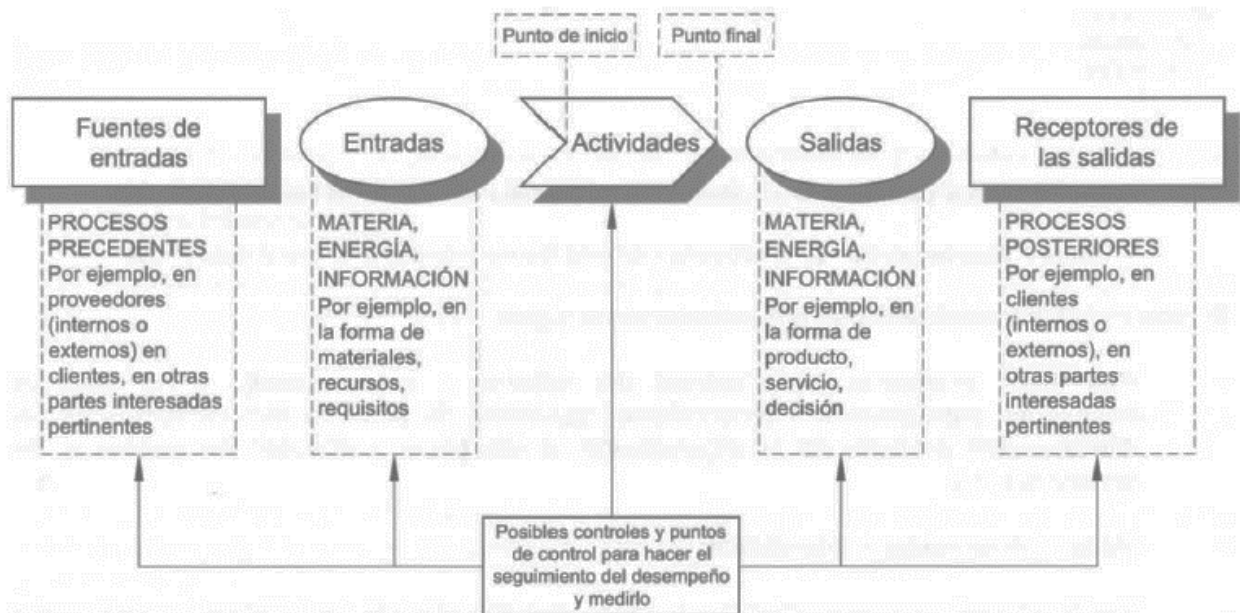
Figura 3. Representación esquemática de los elementos de un proceso Fuente: ISO 9000:2015 p. iii
