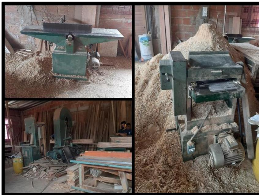
*Nota:* Imágenes donde se observa la ausencia de limpieza y mantenimiento en máquinas estacionarias, Fuente: Elaboración propia.
