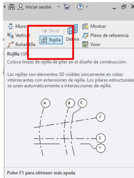
Figura 9. Herramienta de rejilla. Revit. Fuente elaboración propia.
