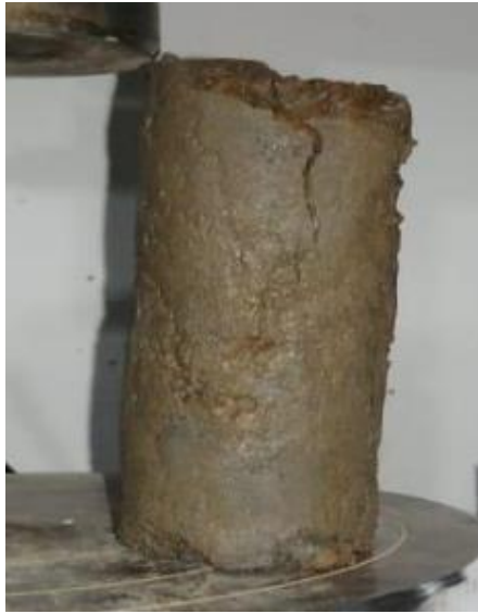
Figura 5 Muestra fallada por el método de compresión inconfiada.
