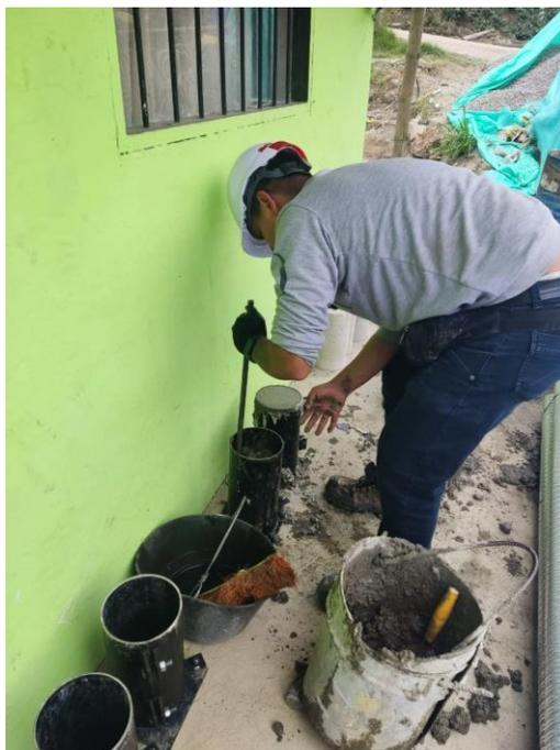
Figura 26 Ensayo de Asentamiento de concreto según la NTC 396.
