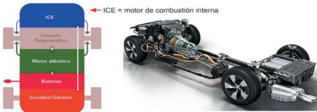
Figura 5: Esquema básico de los vehículos híbridos enchufables [14].
