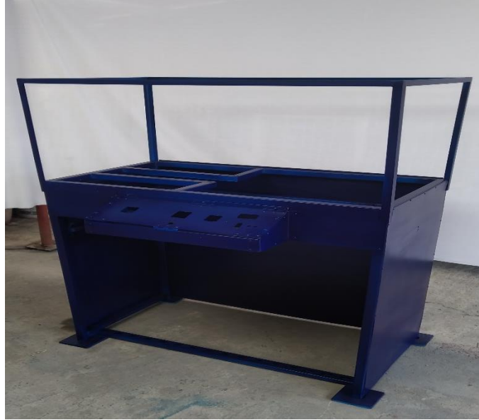
Figura 57: Bastidor o estructura soporte del prototipo totalmente pintado.
