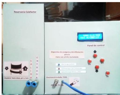
**Figura 3-32.** Panel de control y bores de conexiones
