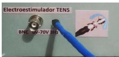
**Figura 3-34.** Bornera BNC de conexión para la electroestimulación.
