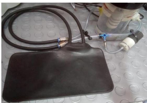
**Figura 3-18.** Conexión final entre el sistema reservorio calefactor y cámara del brazalete
