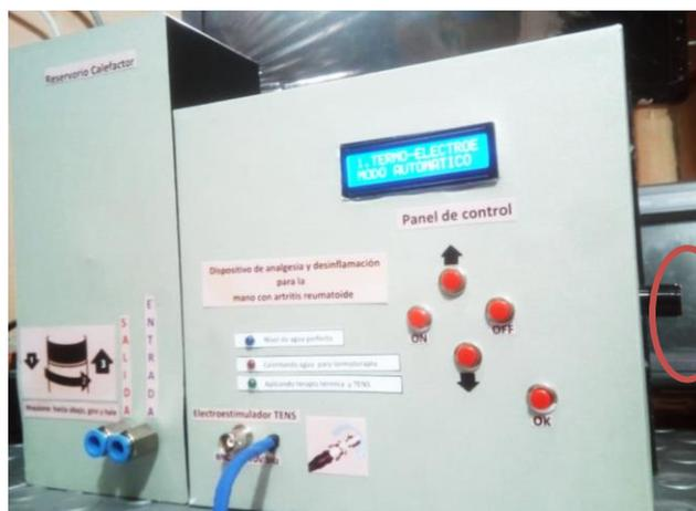
**Figura 3-35.** Vista lateral del dispositivo, en donde el círculo rojo señala la perilla de graduación de tensión del electro estimulador.
