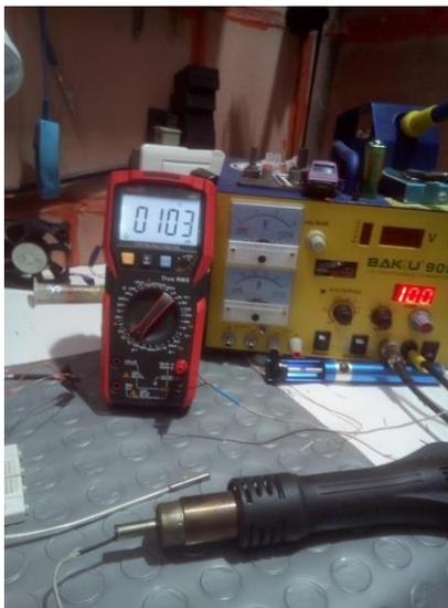
**Figura B-6.** Ajuste de la pistola de calor a 100°C por medio del instrumento patrón en el cual el sensor de temperatura es tipo K. Imagen del autor
