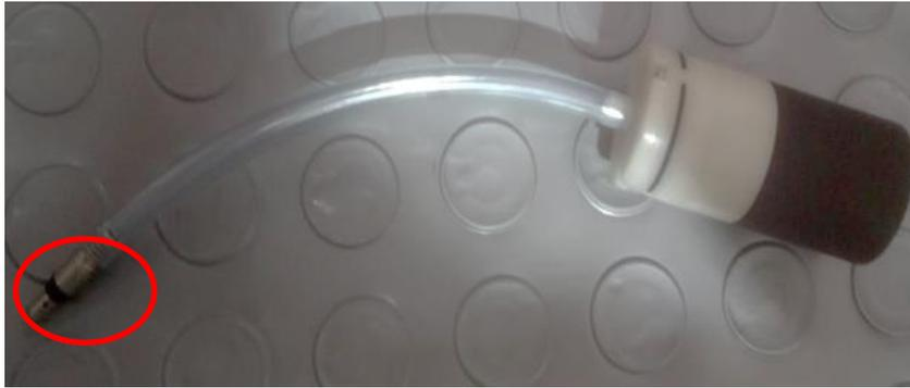
**Figura 3-15.** Acondicionamiento del sistema neumático con válvula de una sola vía o dirección.
