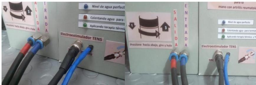
**Figura 3-38.** Conexionado del brazalete al dispositivo.
