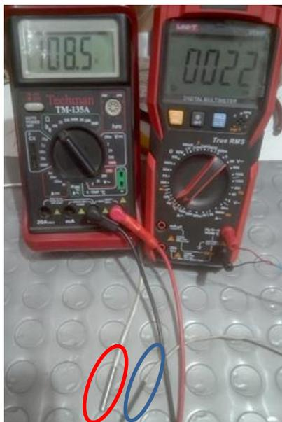
**Figura B-4.** Comparación entre la lectura de la resistencia de la pt 100 con relación a la temperatura ambiente del equipo de medición patrón. Imagen propia del autor
