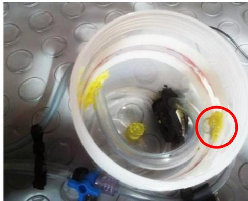
**Figura 3-16.** Vista superior del sistema conexionado interno hidráulico del reservorio calefactor
