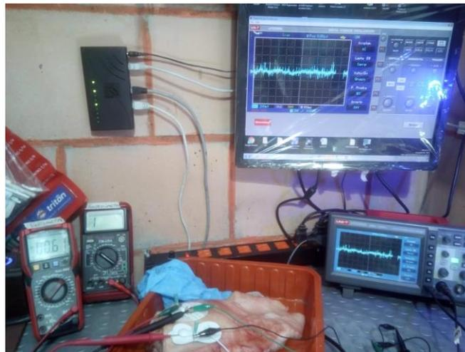
**Figura 3-59.** Señal de comportamiento de la electroestimulación y el musculo por medio de las adquisiciones de electrodos tipo aguja.
