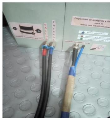
**Figura 3-39.** Aislante térmico en los conductores del electro estimulador y bus de datos.
