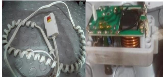
**Figura 3-31.** Enchufe GFCI o diferencial con cable de alimentación flexible.
