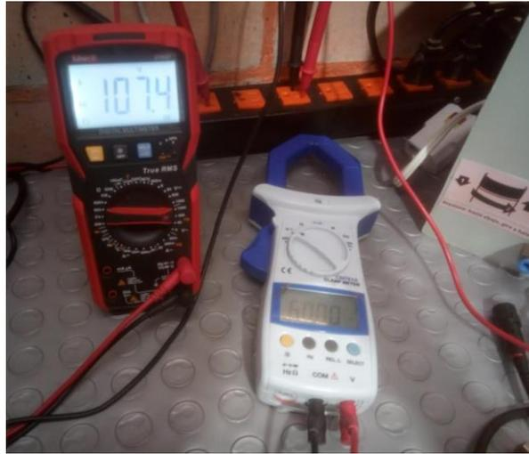
**Figura 4-4.** Medición de la red eléctrica AC para la realización del segundo ensayo
