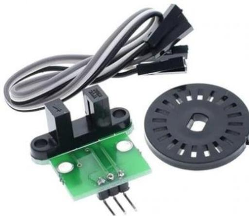
Nota. En la imagen se observa el Encoder HC -020K que será utilizada para medir la velocidad de cada una de las llantas para poder calcular la velocidad total del robot. (Libre, 2020)
