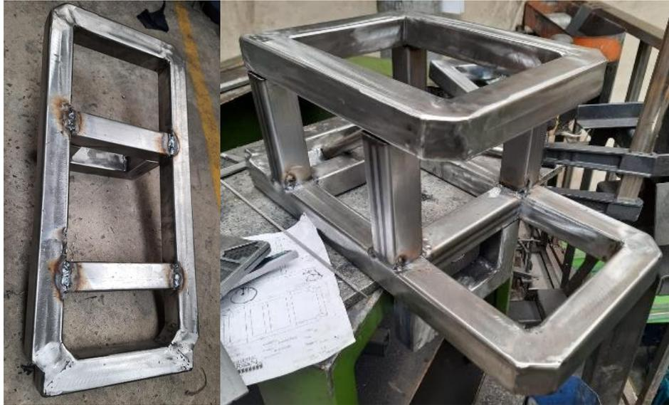
Nota. Chasis del robot completamente construido (Propia).
