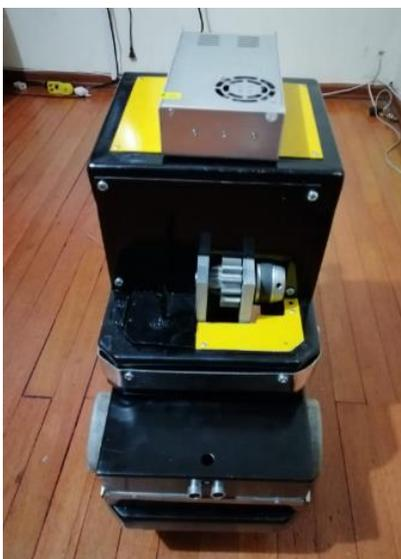
Nota. En la imagen se muestra la implementación del circuito electrónico con el control PID, en la donde se realizan pruebas con una fuente regulada de 12 V. (Propia)
