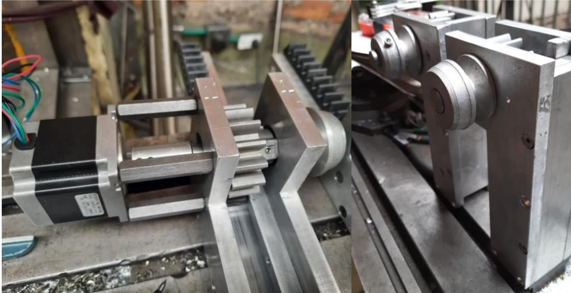
Nota. Mecanismo de sembrado ensamblado completamente (Propia).
