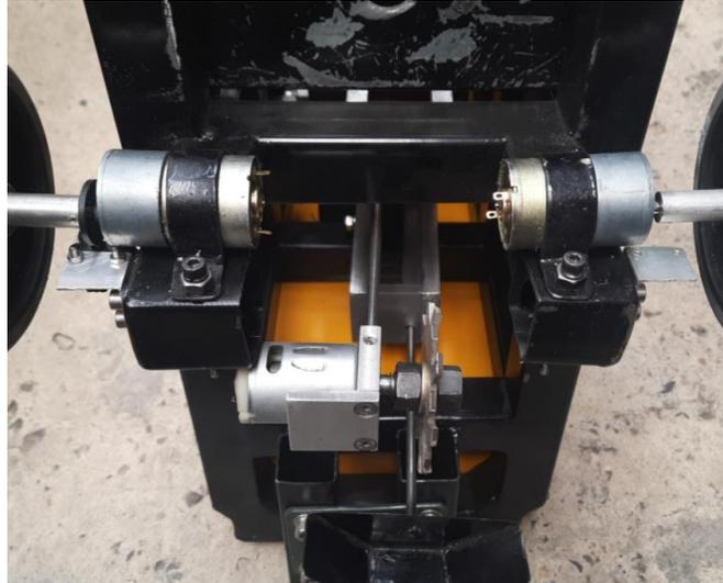
Nota. En la imagen se observa la distribución de los motores para el mecanismo de siembra y el disco de perforación. (Propia)
