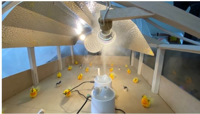
Figura 29: Pruebas de concentración de humedad relativa
