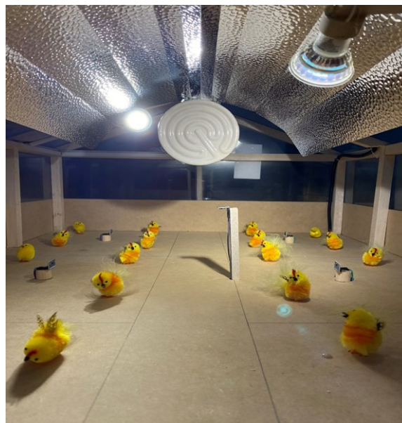
Figura 28: Prototipo en precalentamiento para la toma de muestras, sistema de calefacción infrarrojo cerámico.
