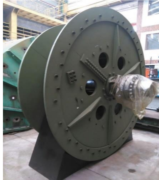
Figura 4. Tambor de elevadora soldado y pernado, Registro fotográfico NAVAR S.A.S
