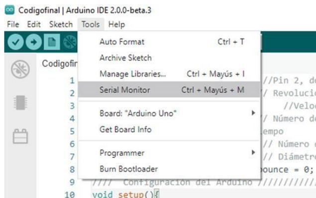
9. Seleccionamos el serial monitor para poder visualizar los datos
