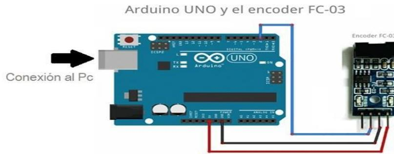
Figura 11 Conexiones del encoder y Arduino
