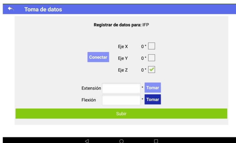
En el momento en que la aplicación se conecta con el dispositivo, el operador podrá poner los indicadores en 0° para obtener el punto de referencia y el registro del ángulo entregado por el dispositivo (ver Figura 4-10).
