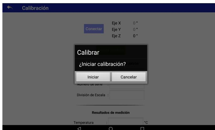
Para el procedimiento de calibración se requieren, al menos, 12 puntos de medida (CEM, 2019); sin embargo, se deja la posibilidad de indicar cuántos puntos serán utilizados para el procedimiento (ver Figura 4-18). La aplicación iniciará el procedimiento, solicitando el valor medido por el equipo y el valor real del patrón (ver Figura 4-19).
