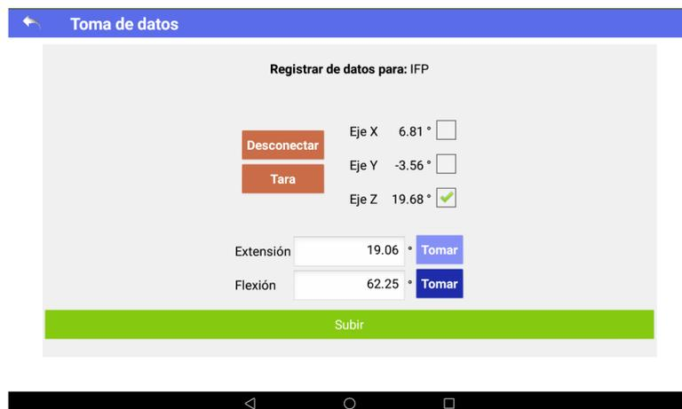
Al guardar los valores obtenidos por el dispositivo, la aplicación le solicitará confirmación al operador para almacenar los datos en la nube (ver Figura 4-11).
