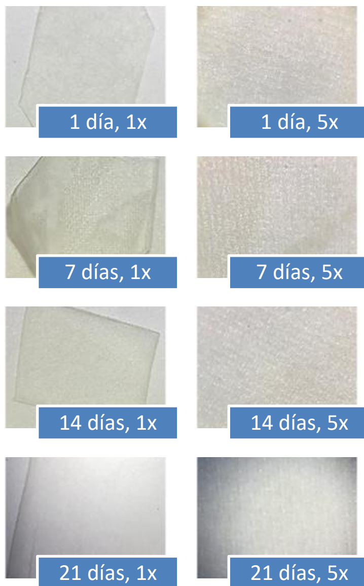
Imagen 9. Estereomicroscópio (fotografía), Observación a 1x y 5x de membrana Biomed con suero fisiológico según los tiempos establecidos 1,7,14,21 días
