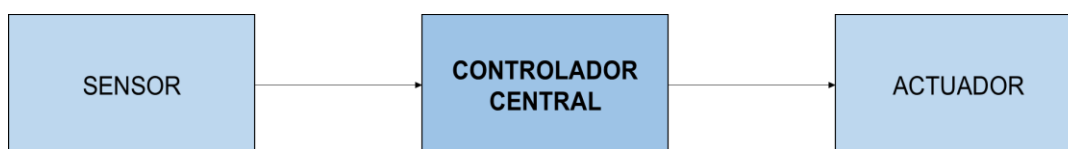
Ilustración 3-11. Arquitectura centralizada general de la instalación
