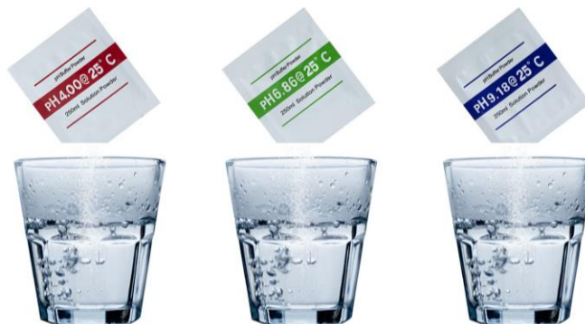
Figura 2-11: Soluciones de calibración de pH. Fuente: (Amazon.Com: Paquete de 15 Soluciones de Calibración de Búfer de PH En Polvo 4.00/6.86/9.18 Para Calibrar Con Precisión El Medidor de PH, Fácil y Preciso Paquetes de Polvo de Calibración Del Probador de PH : Industrial y Científico, n.d.)
