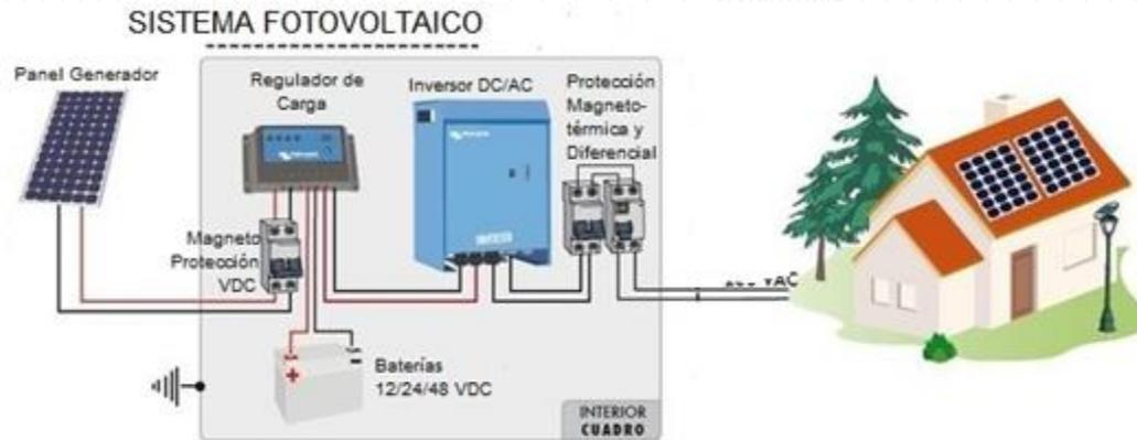
Ilustración 4 sistema fotovoltaico
