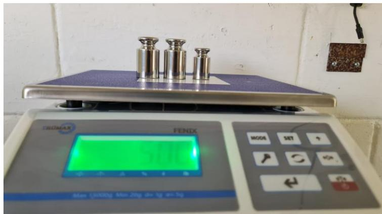
Figura 4. Balanza Trumax para le medición del consumo específico de combustible
