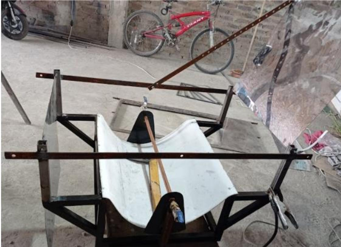
Concentrador solar canal parabólico en estado de construcción. Autores, 2022.
