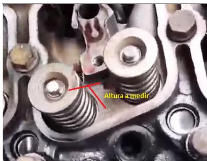
Figura 35. Medición predictiva del desgaste en válvulas y asientos.
