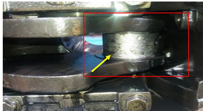
Figura 3. Cigüeñal fracturado. fuente: autor.
