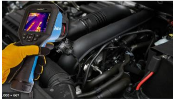
Figura 7. Vista de cámara termográfica analizando un motor de combustión.[16].
