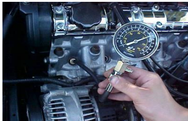
Figura 8. Medición de presiones de compresión de cilindros.
