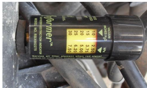
Figura 9. Medidor estado del filtro de aire.
