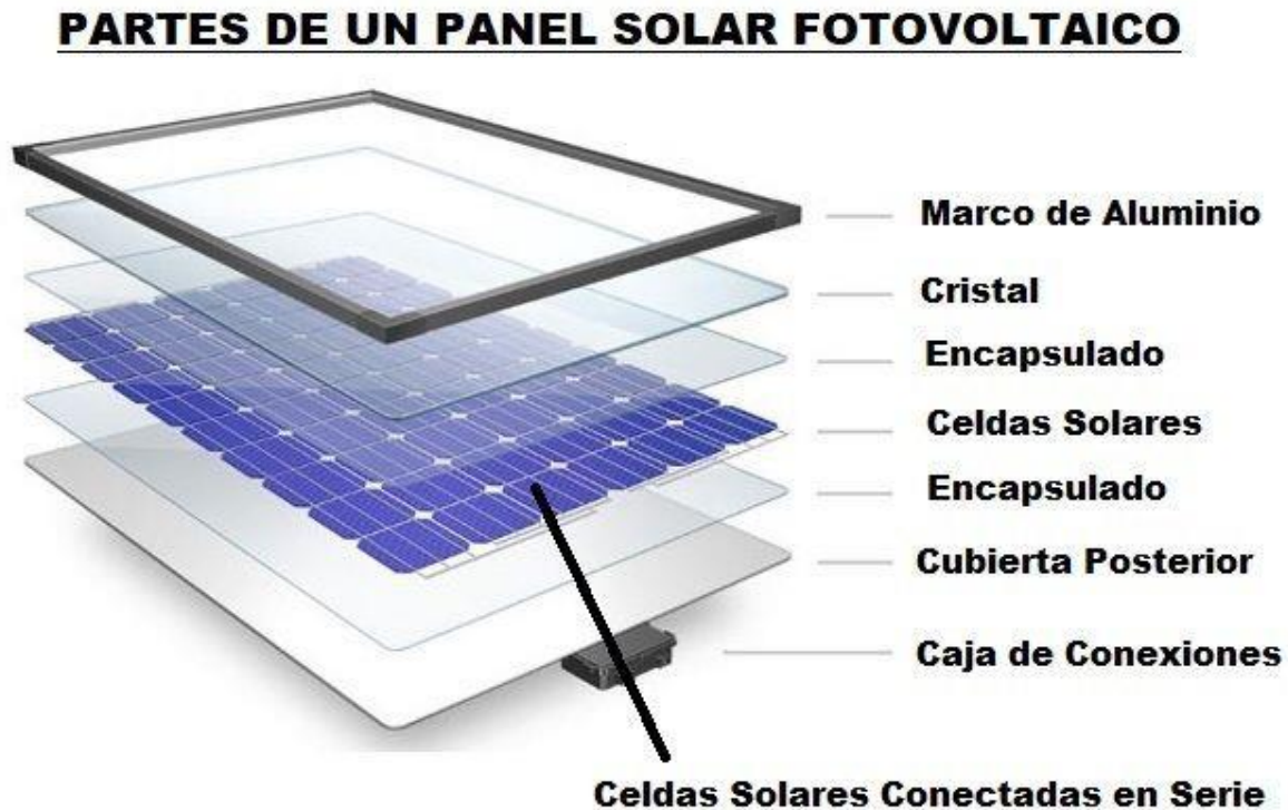
Figura 12. Partes de un panel solar fotovoltaico
