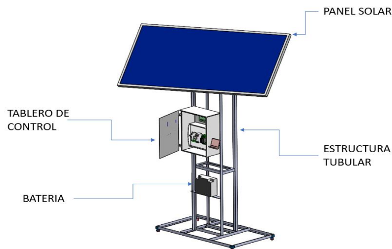
Figura 11. Partes del Sistema Fotovoltaico
