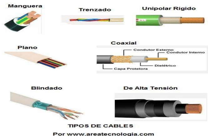
Figura 24. Tipos de cables y conductores
