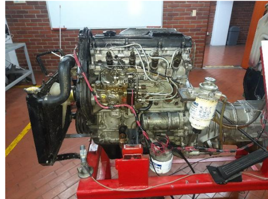
Figura 11. Lateral frontal: Motor de arranque, inyección, bloque.
