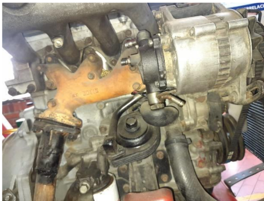
Figura 10. Lateral trasero: alternador (Código# 003), escape, bloque y otras partes.
