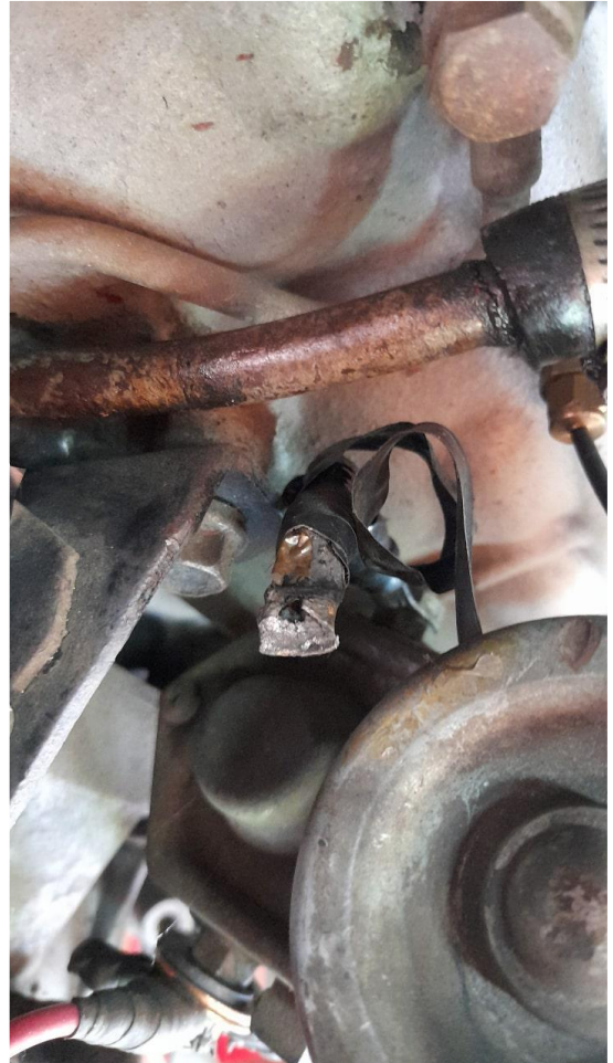
Figura 8. Motor de arranque y conexión rota. (Código# 004)
