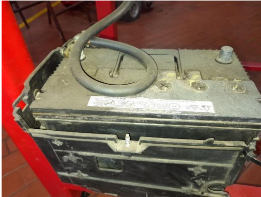
Fig.5 Bateria con un voltaje de 5.64 V, es de 6 celdas de electrolitos, no está marcada, ni con su sello de marca, pero el tipo de caja es similar a la 34I, esto nos indica que es posible que sea una bateria de los 850 a 900 amperios. (Código: #001)
