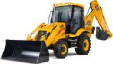
A yellow backhoe loader with a front loader bucket and a rear backhoe arm.     | <p style="text-align: center;"><b>Retroexcavadora</b></p> <p>Máquina autopropulsada sobre ruedas con un bastidor que monta a la vez un equipo de carga frontal y otro de excavación en la parte posterior, de forma que puedan ser utilizados alternativamente.</p>                                                                                                                                  |
