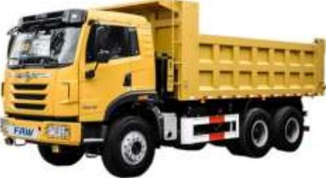
A yellow dump truck with a large cargo bed, used for transporting materials.   | <p style="text-align: center;"><b>Volqueta</b></p> <p>El camión de volteo es, quizá la máquina más conocida para el transporte de materiales en excavaciones, construcciones y minería.</p>                                                                                                                                                                                                          |
