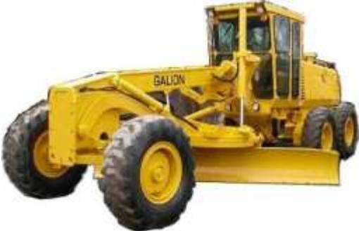
A yellow Galion motor grader with a large blade, used for grading and leveling. | <p style="text-align: center;"><b>Motoniveladora</b></p> <p>Máquina autopropulsada utilizada para dar un acabado perfecto a la operación de extendido o nivelación, moviendo pequeñas cantidades de tierra a poca distancia.</p>                                                                                                                                                                     |
