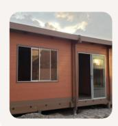
Los muros WPC son livianos, fuertes, termoacústicos, con acabado (color) y se instalan rápido. Ideales para construcciones (casas, aulas,etc) y cerramientos.
