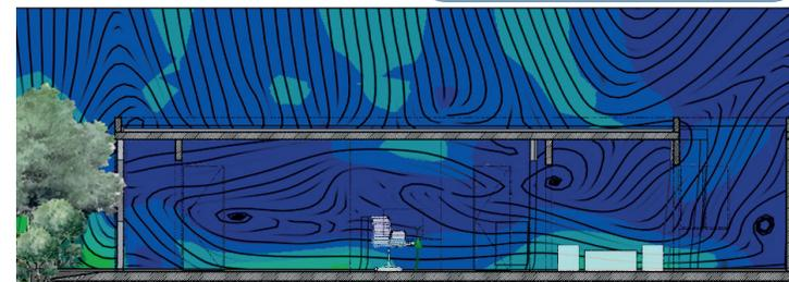
Simulación de Vientos en la vivienda con vegetación exterior, sin corrientes de aire exteriores
