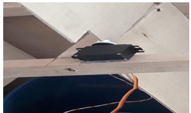
Fig. 29: Instalación de servomotores
