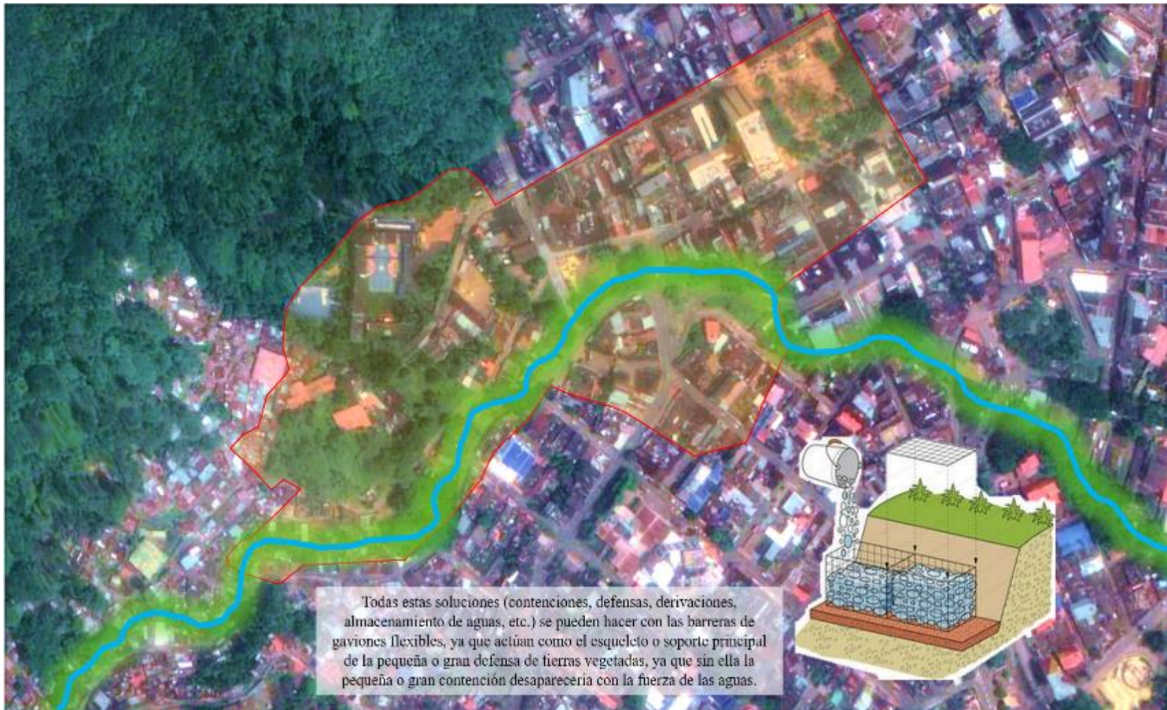
Ilustración 11. Ronda hídrica del Caño Gramalote, donde se proyectaría la construcción de gaviones para el control de la misma.
