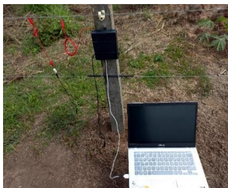
Figura 4.13 Recoleccion datos cerca en falla mala
