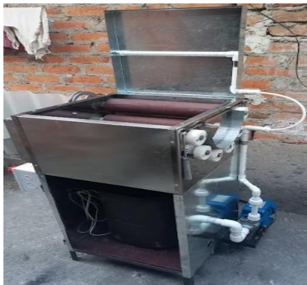
Fig. 18: Montaje y conexión de bomba
