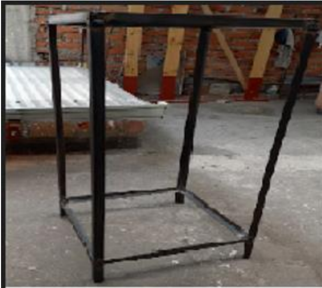
Fig. 12: Estructura de ángulo de hierro de 1.5"
