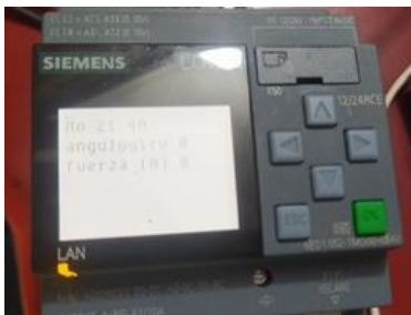
Fig. 12. Pantalla PLC inicio ensayo a torsion.
