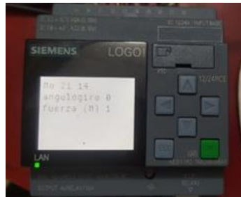
Fig. 9. Pantalla PLC inicio ensayo a torsión.
