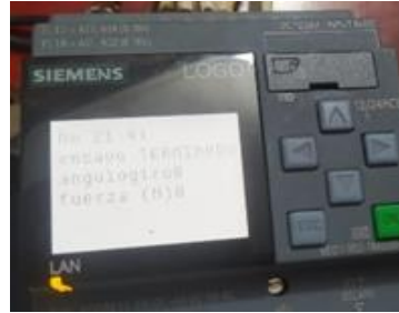
Fig. 14. Pantalla PLC culminación ensayo rotura probeta
