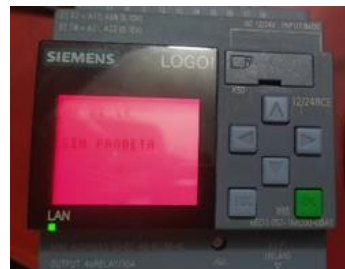
Fig. 10. Pantalla PLC con mensaje "sin probeta"
