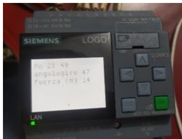
Fig. 13. Pantalla PLC ejecución ensayo a torsion.
