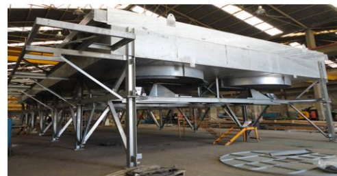
Fig. 3. Aeroenfriador. Fuente: Los autores.
