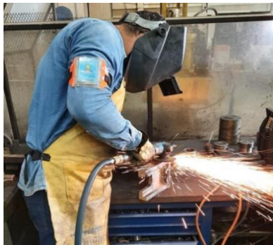
Fig. 21. Pulido de exceso de soldadura. Fuente: Los autores.
