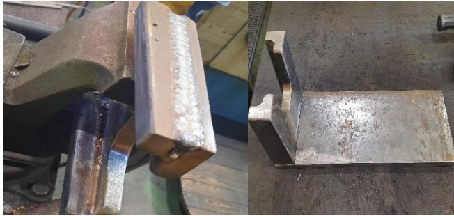
Fig. 20. Acabado y aplicación de soldadura 7018. Fuente: Los autores.
