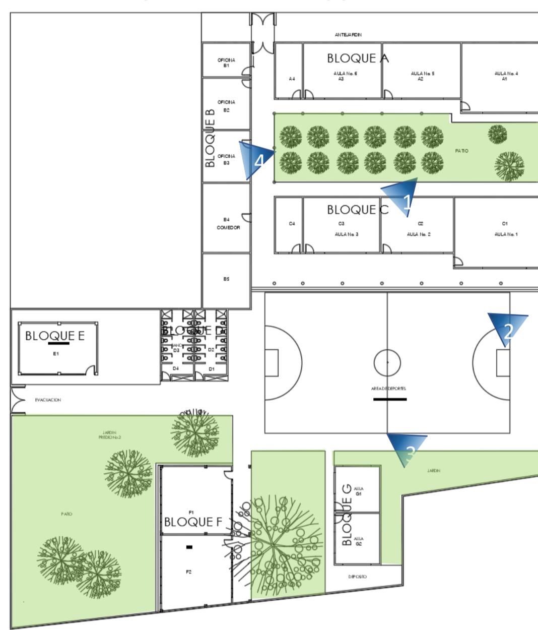
PLANTA EXISTENTE PRIMER PISO ÁREA: 3,851 M 2
