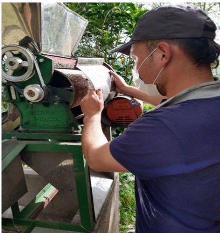
Figura anexo 6: Extraccion de la tapa protectora del tambor
