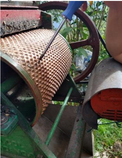
Figura 20: Fallas en la camisa de cobre.
