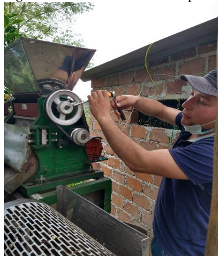
Figura anexo 7: Extraccion de la polea
