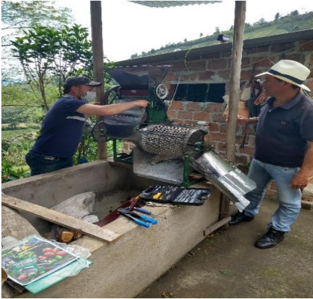
Figura 20: Fallas en la camisa de cobre. En la imagen se puede observar las fallas que presenta la despulpadora del caficultor en la camisa de cobre donde presenta desgaste y por consiguiente el mal despulpado y quebrado del grano.
