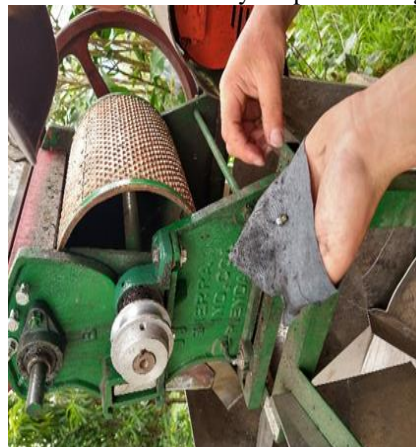
Anexo 8: Extraccion y limpieza de engrases
